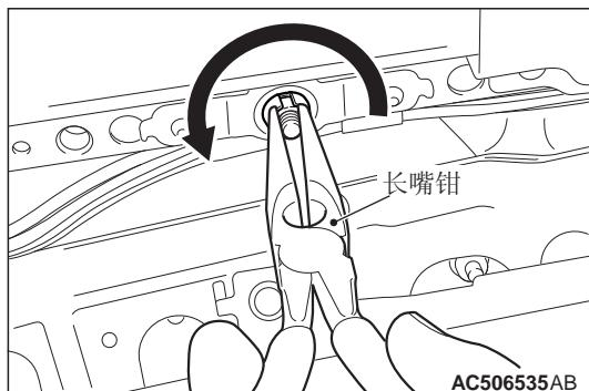
将天窗总成沿图示的方向转动，同时使用长嘴钳或类似工具将其拆下。
